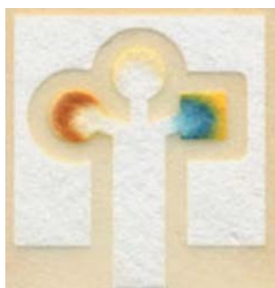
Figura 1. Muestra de papel empleada para la detección de glucosa (compartimento de la dcha.) y proteínas (en el compartimento de la izq.).
